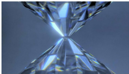
試料をダイヤモンドの間にはさんで100万気圧以上をかけることで、 地球内部の状況を実験室で再現
