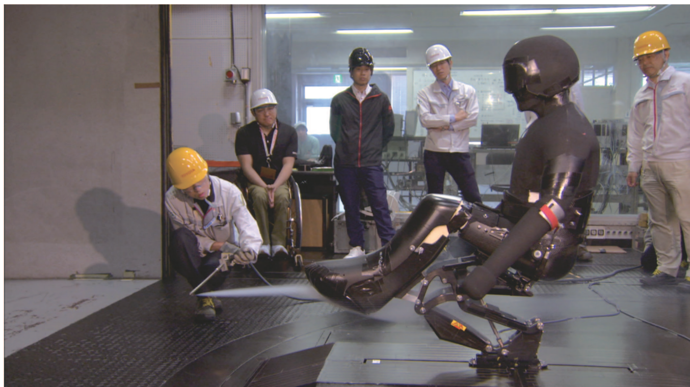
開発中のチェアスキーの空力特性実験を行なう様子 TV:54分
