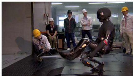
開発されたチェアスキーの空力特性実験を行なう様子
