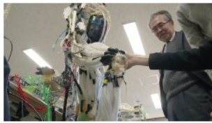
細径人工筋肉を用いた筋骨格ロボット
