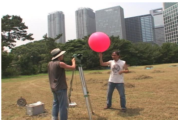
風の道を探す実測調査
