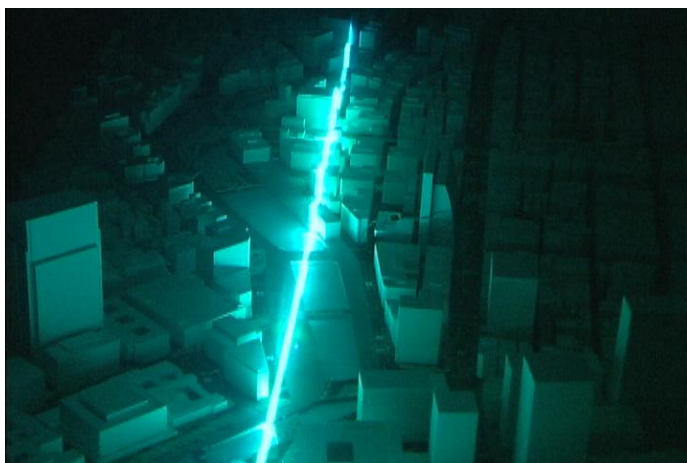
風洞実験で風の道の効果を確認
